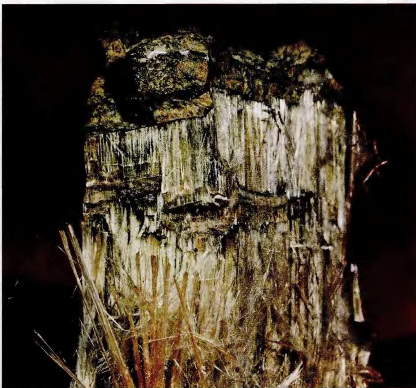
▲ 石棉晶体原本具有玻璃光泽，但如果结晶成纤维状，就呈现出了柔滑的丝绢光泽。
