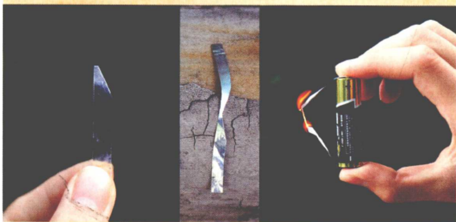
▲ “电池锡纸法”取火成功的关键，在于锡纸的尺寸：宽5毫米，最窄处2毫米最为合适。
