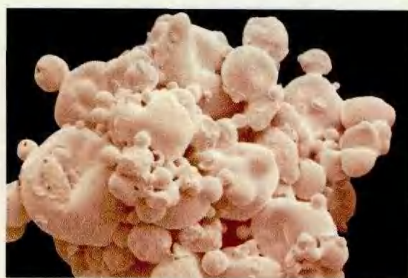
▲奶粉颗粒充满孔洞，有利于水分进入内部。
