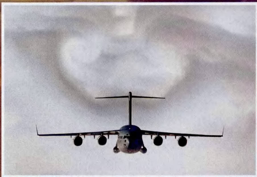
▲ 美军C-17运输机发射干扰弹后，形成了一朵类似“天使翅膀”的云。其中漩涡部分是飞行时机翼形成的螺旋形气流，其余部分则是干扰弹散发出来的烟雾。
