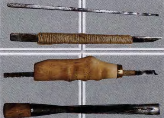
凿刻工具 雕版时用到的各种刀具 和凿具
