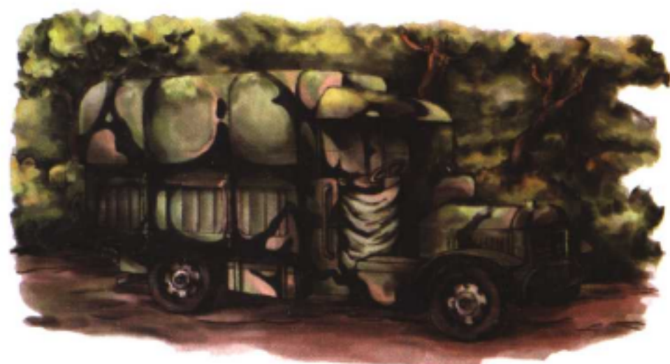
迷彩的另一个要素就是：将立体的、三维的物体转化成二维的、平面的。这张军用车辆的效果图或许能说明问题。一辆普通的军绿色军用车辆，它的立体感很强，而当它被涂上迷彩图案之后，车体被大大小小的色块分割成斑块，立体感就被削弱了，而当它被放置进背景环境之中后，就很容易让人迷惑了。
