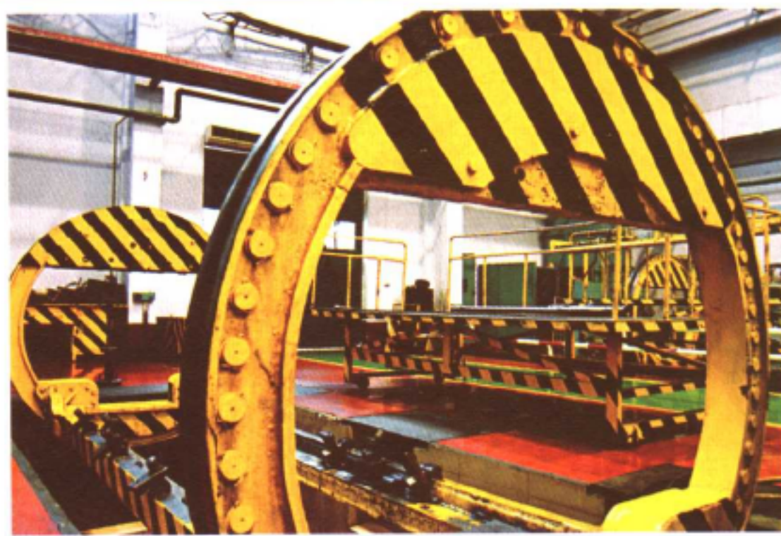
四川资阳机车厂的机车翻转台：机车的底座是技术含量最高的部分，而翻转台就是为了把重量很大的半成品机车底座翻过来，使其底面朝上以便加工。
