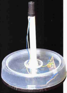
A · 10 碟装 CD 光盘盒 B · CD 光盘 C · 电线插头 D · 6 瓦灯管(带镇流器) E · 电烙铁
