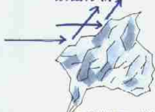
a、在强风作用下，褶皱的顶棚会受到很大的压力；
