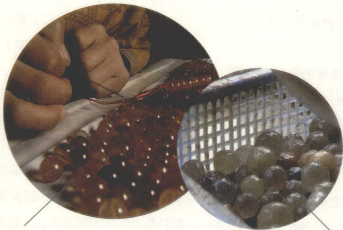
经过三天左右的初磨、中磨、细磨、再抛光的过程，水晶才呈现出人们平时认得的模样。
