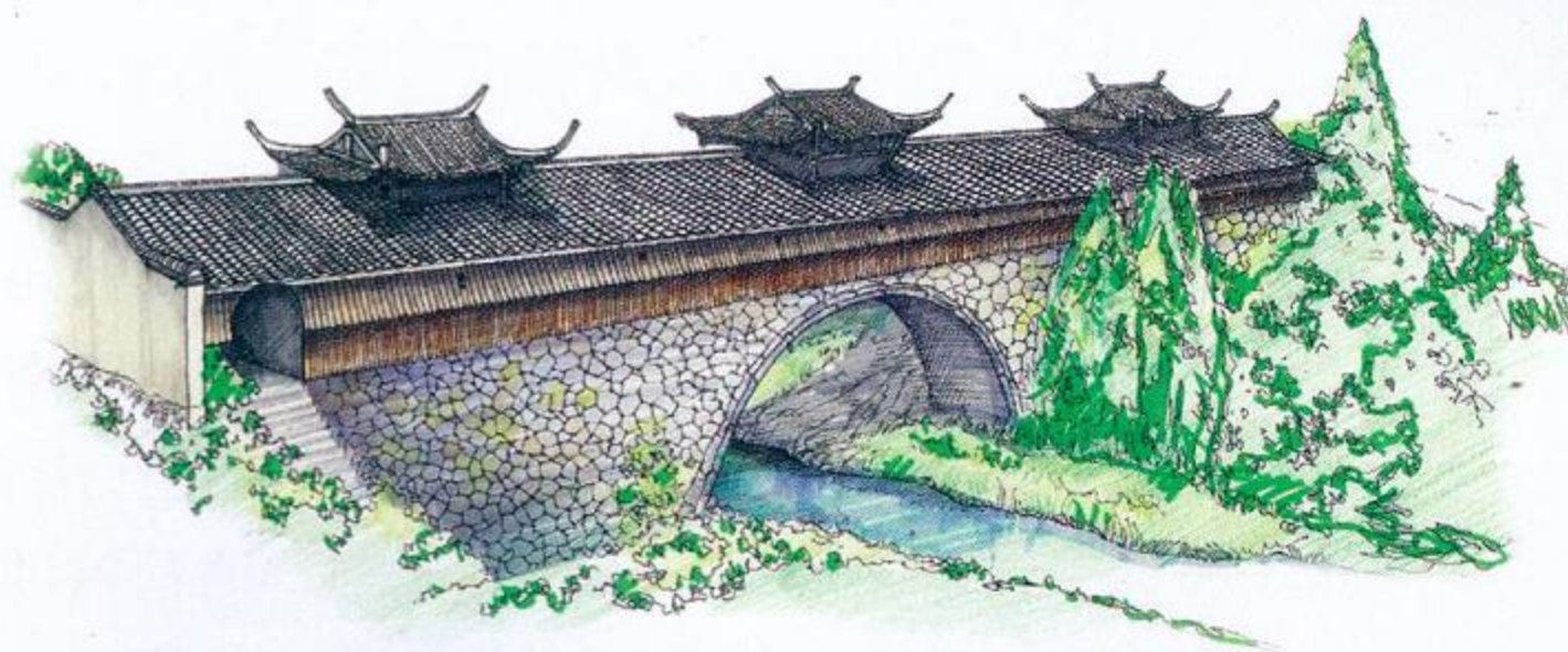
单跨式石拱廊桥
