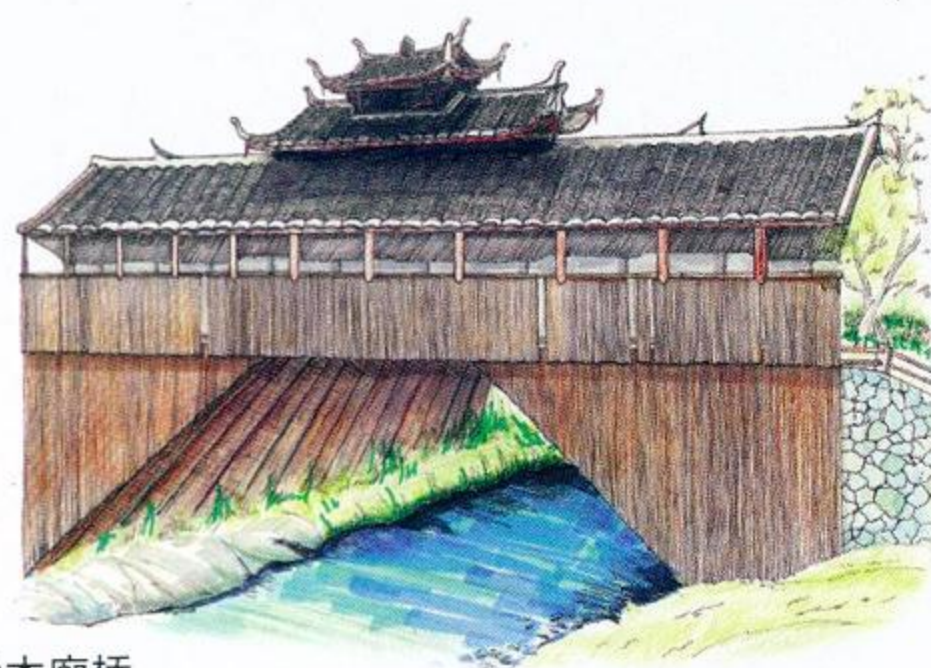
斜撑式平梁木廊桥
