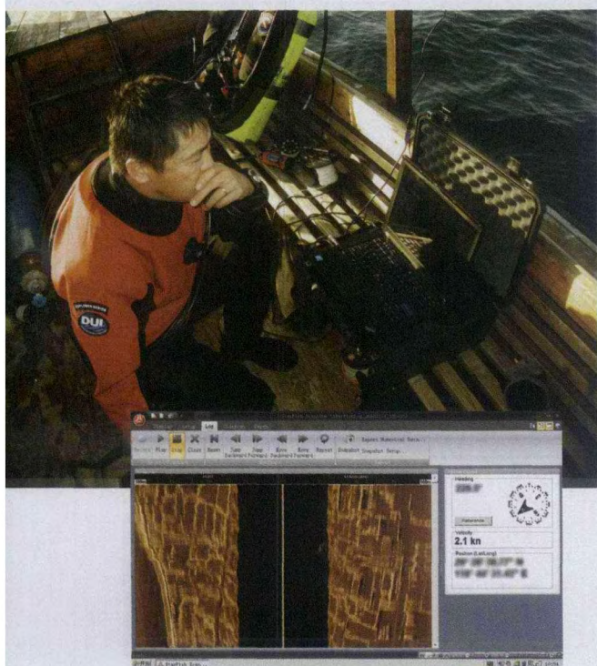
▲ 潜水员在水中对建筑进行仔细的测量和记录。▼ 在下水之前，摄影师利用侧扫式声呐探测仪对水下古城进行探测。
