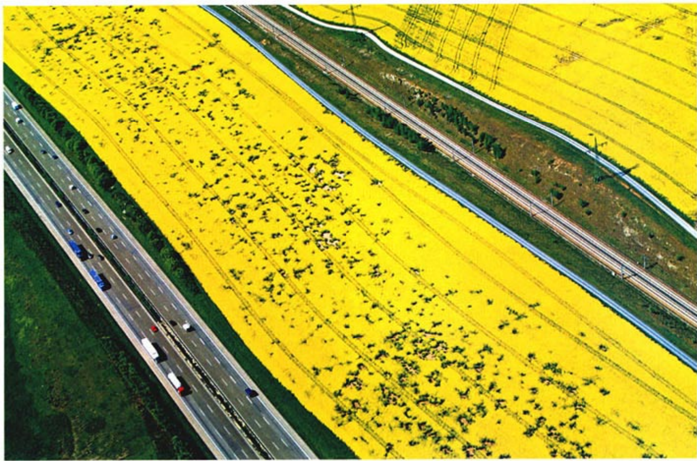
○ 在德国法兰克福和科隆之间，六道高速公路与高速铁路在二百多公里的路段上“并肩而行”，中间相隔着油菜花带。图中，右上较粗的灰线为电气铁路，左下为双向高速公路。摄影／Zimmermann
