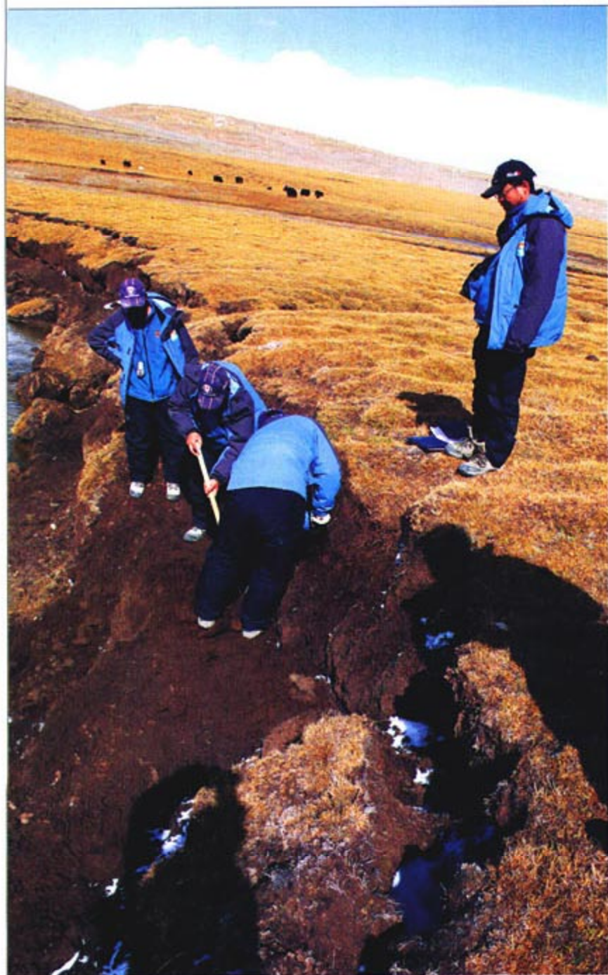
◎ 2008年10月，青海三江源头科学考察队在黄河源区进行冻土挖掘，工作人员遗憾地发现他们竟然无法挖到冻土层！据当地人员介绍，上世纪七八十年代，黄河源区地表1米以下即为冻土层，现在则要到两三米处才是冻土层，黄河源区冻土层下降问题已经非常严重。摄影/张超音
