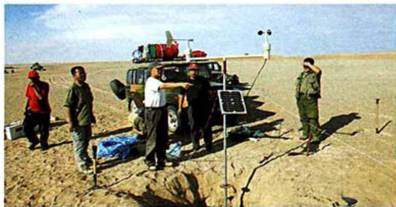
科考队员在沙漠里架设固定式卫星气象观测站
