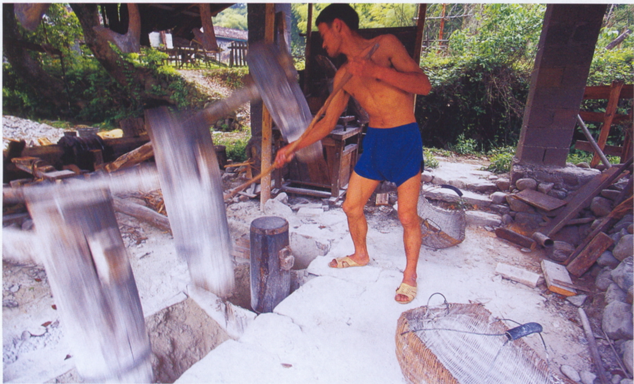
水碓春打瓷石 瓷石采集后，先以人工用铁锤敲碎至鸡蛋大小的块状，再利用水碓春打成粉状，然后经过淘洗、沉淀、除渣、稠化去水，最后制成形似砖状的泥块，俗称白不子。这种瓷石加工方法历史悠久，应与景德镇制瓷历史同步。 摄影 / 关海彤
