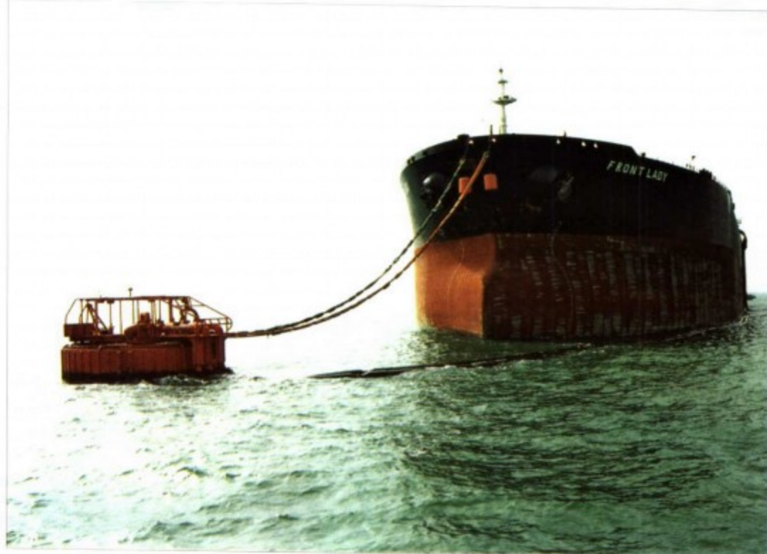
超级油轮通过单点系泊装卸石油系统，可以安全、节约地把船舱中的石油送往陆地并运输炼油厂。
